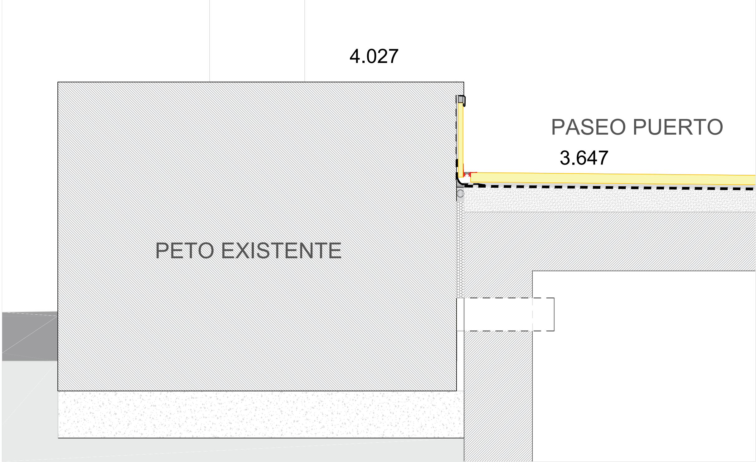
DETALLE ENCuentRO PETO EXISTENTE-CUBIERTA REHABILITADA. ESCALA: 1/10
